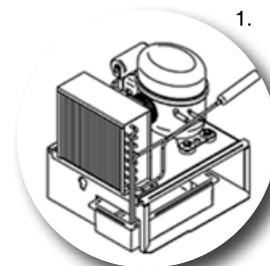
○ La MASCHERINA COPRIMOTORE ora si apre lateralmente come una porta ed è dotata di una chiusura con magnete. Questo sistema facilita l'accesso al vano motore ma soprattutto al condensatore per effettuare le periodiche operazioni di pulizia. Inoltre abbiamo spostato il termostato nella parte alta del vano motore, dove, grazie ad una posizione più protetta e ad un ambiente privo di umidità, si preserva maggiormente la vita del termostato (foto 2).
