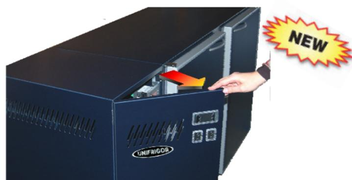
Nuove mascherine coprimotore con apertura laterale, simile a quella di una porta ma con cerniere a libro e chiusura con magnete. Questo sistema facilita l'accesso al vano motore ma soprattutto al condensatore per effettuare le periodiche operazioni di pulizia. Inoltre abbiamo spostato il termostato nella parte alta del vano motore, dove, grazie ad una posizione più protetta e ad un ambiente privo di umidità, si preserva maggiormente la vita del termostato.
