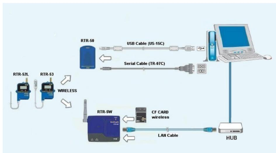
Questo piccolo e versatile registratore di dati, è disponibile in due versioni, una che registra solo la temperatura (mod. RTR-52L), ed una che registra sia la temperatura che l'umidità (mod. RTR-53). Può dialogare con la base ricevente collegata al PC indifferentemente sia via radio, che per mezzo di un sensore ottico che di fatto rende il nostro registratore del tutto simile nella modalità di funzionamento anche ad un **"data logger"** classico, di quelli con trasmissione di dati a contatto.
