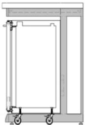
4. avete un apparecchio che si incassa perfettamente nel vostro arredamento senza richiedere alcuna modifica strutturale con dimensioni perfette per l'incasso sia in larghezza 1190 mm, compreso il gruppo motore, che equivale ad un multiplo della dimensione delle cassettiere standard normalmente utilizzate in questo tipo di arredamento, che in altezza 770 mm comprensivo di ruote.
